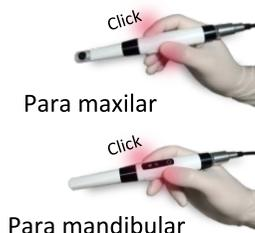
Como hay dos botones de captura en ambos lados de la cámara, el pulgar y el índice pueden proporcionar un apoyo mutuo, lo que se traduce en posicionamiento estable que minimiza el artefacto de movimiento. Esta disposición de botones le permite mantenerse más estable incluso en la fotografía maxilar.
